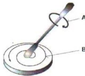
A 棉签转动方向 B 圆弧运动清洁镜片
